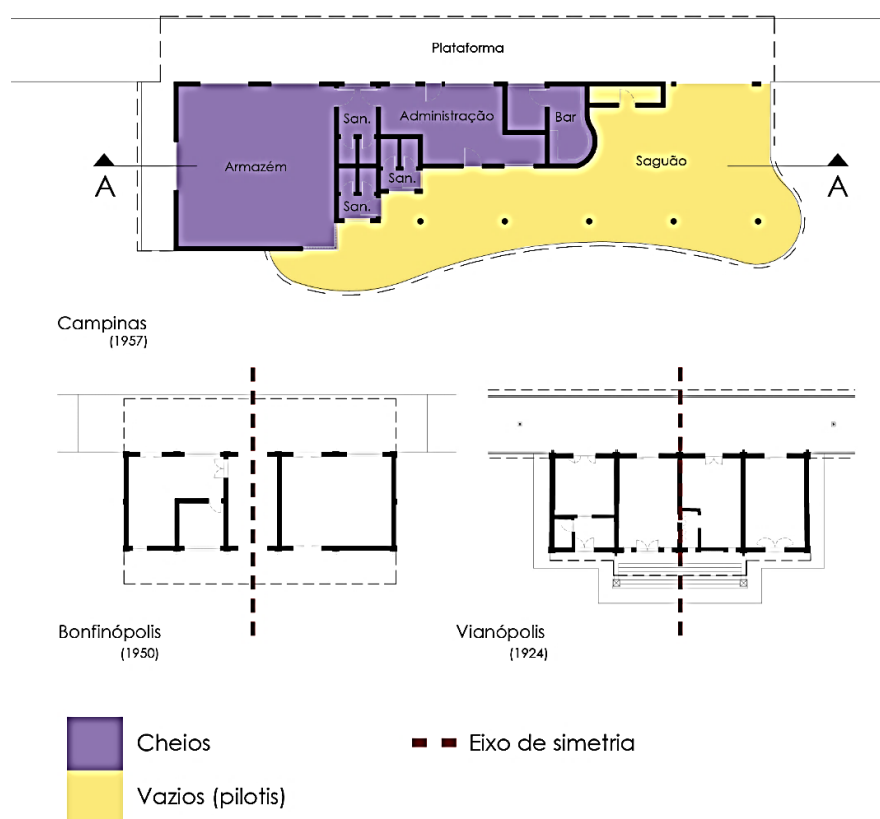
Figura 7. Comparativo das plantas das estações ferroviárias de Campinas (1957), Bonfinópolis (1950) e Vianópolis (1924), da Estrada de Ferro Goiás, indicando os eixos de simetria e a disposição volumétrica da estação de Campinas.
