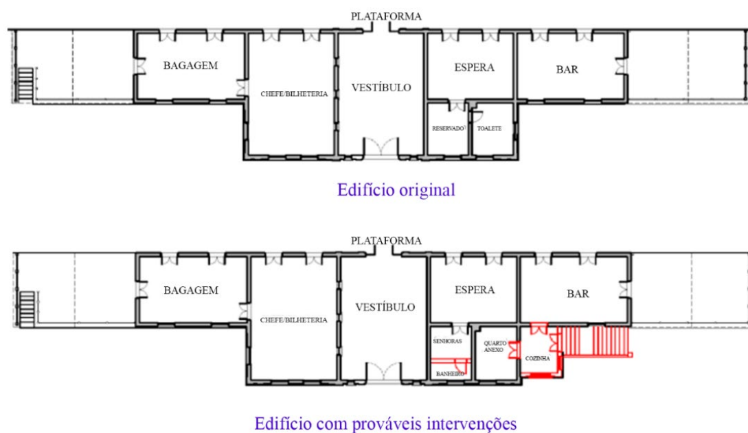
Figura 2. Planta baixa original e de intervenções posteriores da Estação Ferroviária de Pederneiras. Fonte: Silva, 2014, p.177-178.
