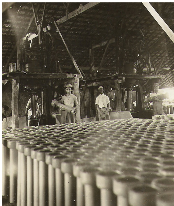
Figura 4. Produção de manilhas em prensa vertical dentro de um dos barracões da Cerâmica Martini, década de 1960.
